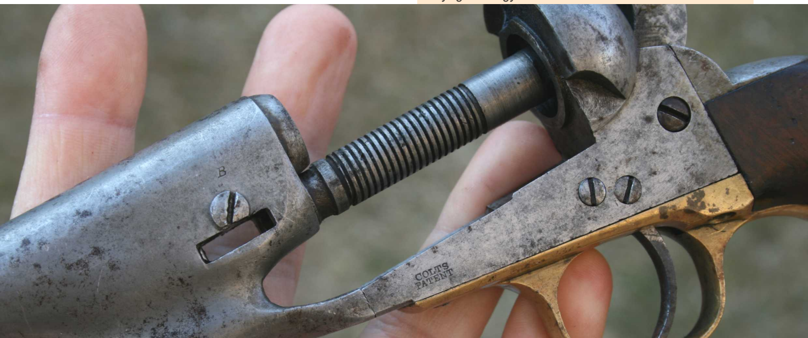
A rögzítőék kivágása eredeti fegyveren - a káros kotyogások egyik oka lehet
