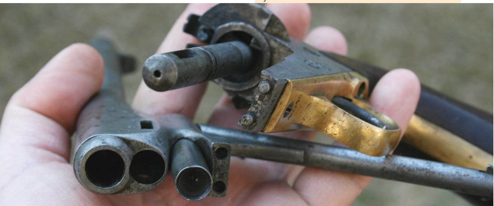
Cső, tok és dobtengely - kritikus pontok minden nyitottkeretes revolveren
